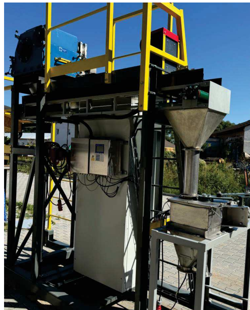
Analyzátor GE4000CM na dávkovacím pase vzorkovače
