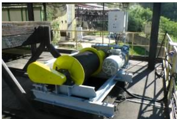
Vrátek EVV2 po modernizaci
