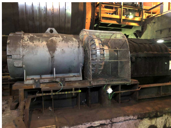
Obr 16.: instalace hydrodynamické rozběhové spojky, jako součásti pohonné jednotky
