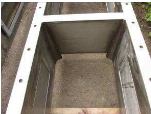
Obrázek č. 4.5.: Příklad násypky do řetězového dopravníku: eliminace „ostrých rohů“, vyrobeno z plechů z NEREZ oceli
