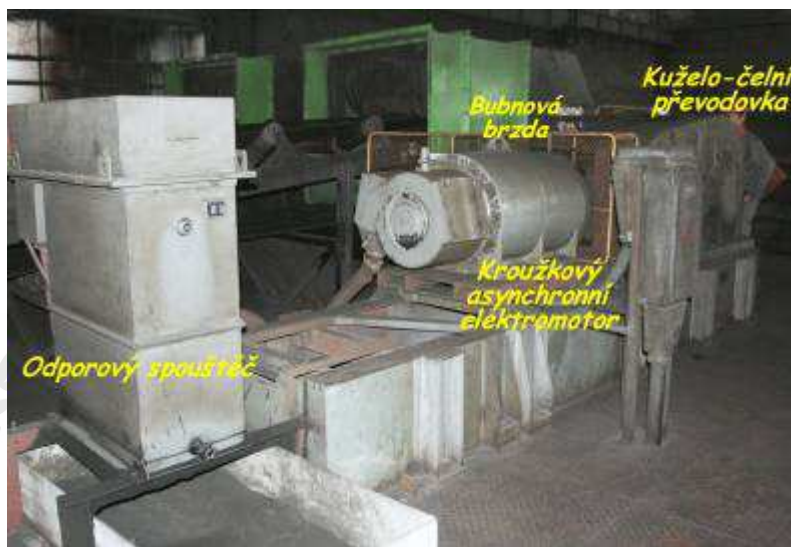
Obrázek č. 11.: původní zastaralý pohon pásu T10B
