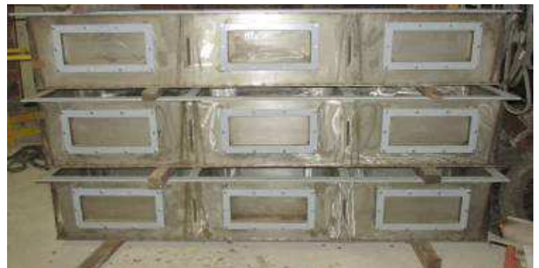
Obrázek č. 4.5.: Příklad násypky do řetězového dopravníku: eliminace „ostrých rohů“, vyrobeno z plechů z NEREZ oceli
