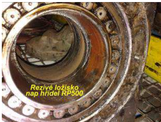
Obrázek 2.: Korodující ložisko hřídele napínací stanice
