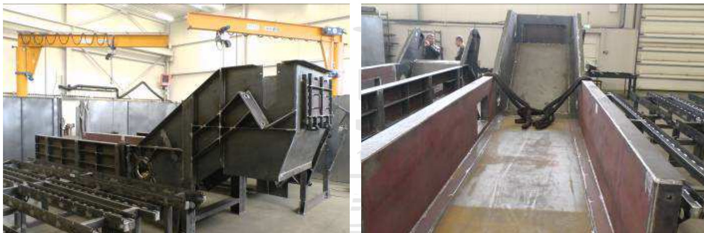
Obrázek č. 16., 17.: svařené části skříní, připravené k penetrační zkoušce
