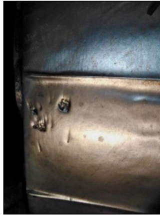
Obr. 6 Poškozená bandáž běhounu
