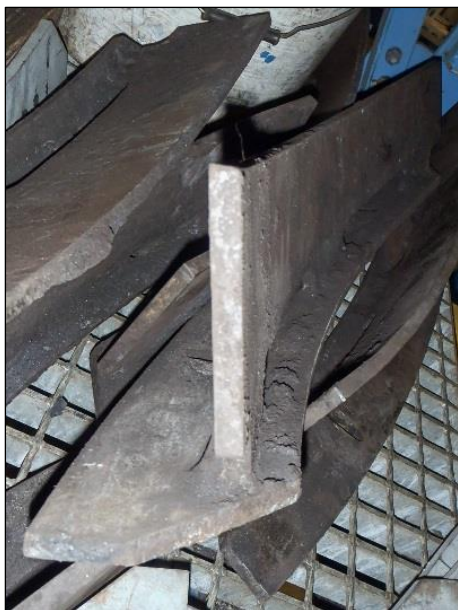
Obr. 4 Segmenty vzdušného kruhu se svislým profilem
