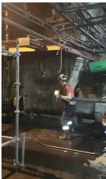
Obrázek 4 a 5 – Mechanické uvolňování uhlí ve svodkách [1]
