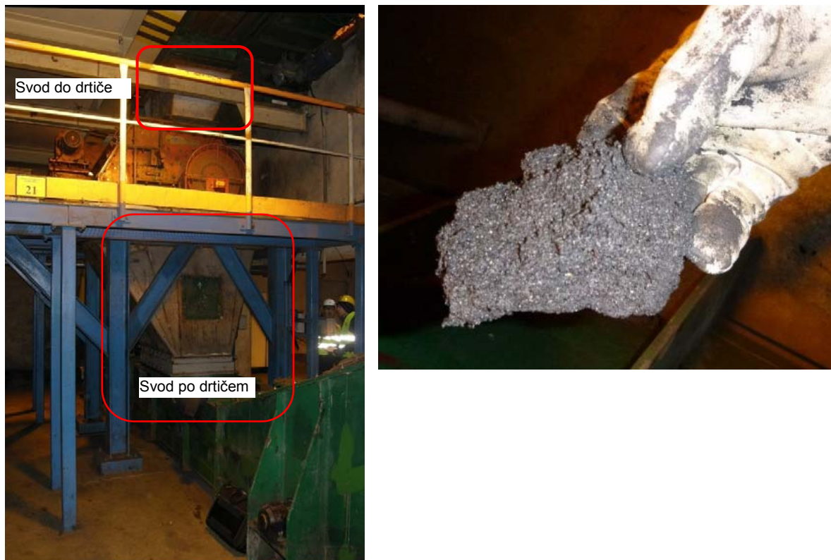
Obrázek 10 a 11 – Technologie drtiče a vzorek ulpívajícího materiálu [1]
