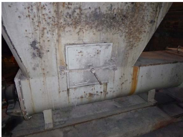
Obrázek 2 a 3 – Svod do šnekového dopravníku a důsledky mechanického obouchávání [1]
