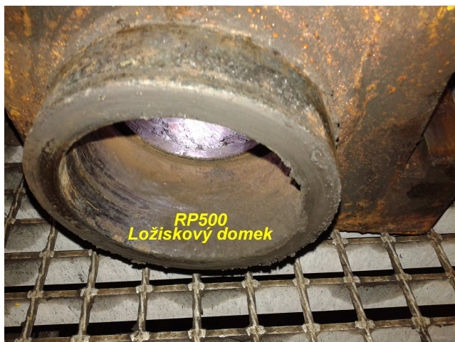
Obrázky 5., 6.: rezivý ložiskový domek a ložisko hřídele napínací stanice
