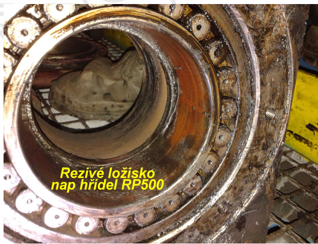
Obrázky 5., 6.: rezivý ložiskový domek a ložisko hřídele napínací stanice
