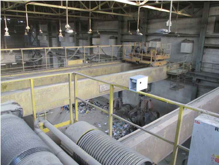
Obrázek č. 1.: Průmyslová bezdrátová kamera KZ-17H na kočce jeřábu
