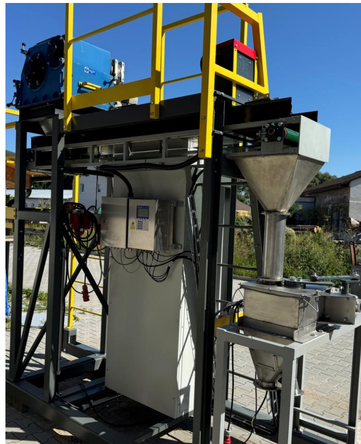
Analýzátor GE4000CM na dávkovacím pase vzorkovače
