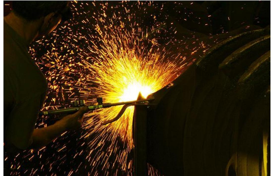
► Separate Anfertigung neuer Brechzähne aus Brennzuschnitten mit kompletter Panzerung
