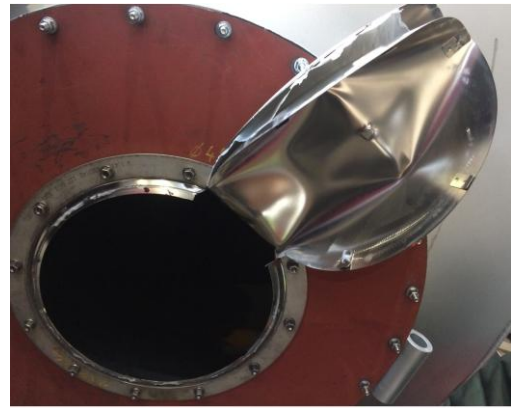
Záběry ze zkoušek VMP DN 450 a snímek membrány po jejím pojistném otevření s následnou výraznou deformací
