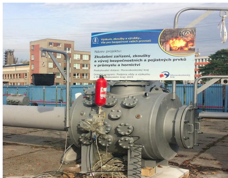
Instalace zkušební nádoby na explozní zkoušky ve venkovním prostoru naší nové zkušebny
