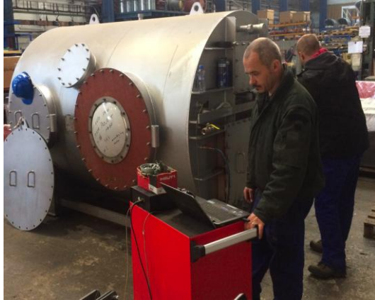
Záběry ze zkoušek VMP DN 450 a snímek membrány po jejím pojistném otevření s následnou výraznou deformací
