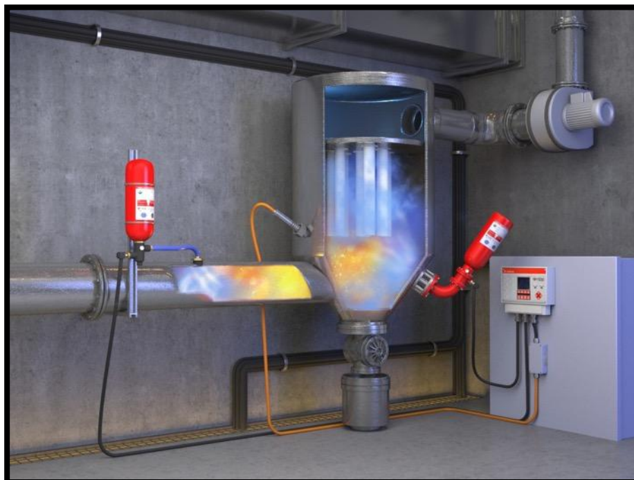
Obrázek č. 6: Schéma instalace potlačení výbuchu v kombinaci s oddělením výbuchu společnosti RSBP spol. s r.o. na filtrační jednotce
