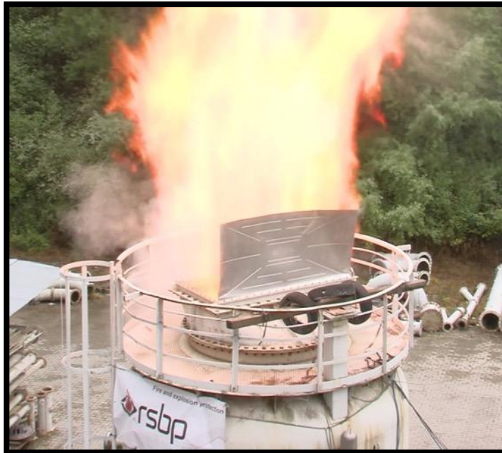
Obrázek č. 5: Ukázka uvolnění výbuchu na testovací nádobě na zkušebně Notify Body v Německu
