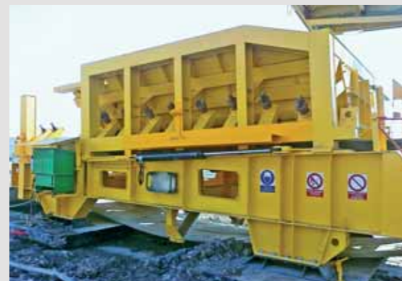
Rekonstrukce vratné stanice pd 520 šíře 1800 mm Rekonstrukce PD 520
