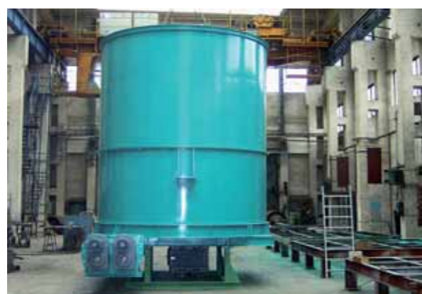
Silo na cementové hmoty Ocelová konstrukce zásobníku, včetně vyhrabovacího zařízení
